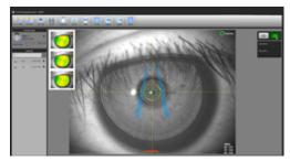
O Topógrafo RM possui o sistema "Auto Meaure" que efetua automaticamente as imagens da córnea após a devida centralização da córnea por parte do operador. É possível configurar que o programa efetue automaticamente até 8 imagens sequenciais
