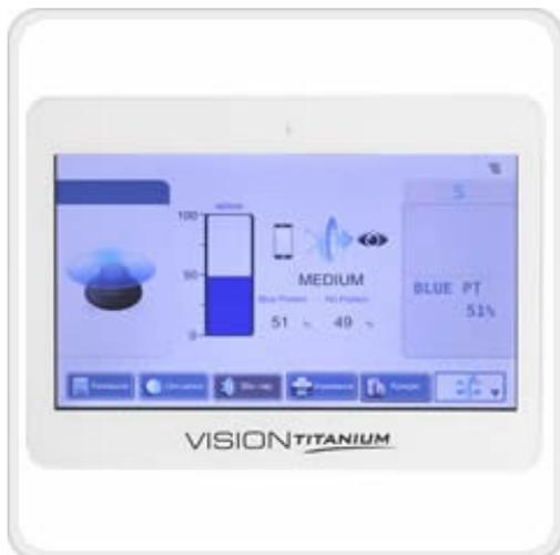
O Lensômetro Vision Titanium apresenta a nova função de leitura de proteção contra raios azuis! O display apresenta uma barra de representação da proteção contra os raios azuis, além da escala em porcentual.
