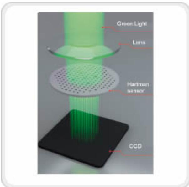
Os sensores SHACK HARTMANN do Vision New efetuam uma análise em 140 pontos da lente. Performance e precisão muito superiores aos lensômetros convencionais.
