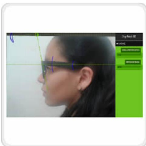
Através do módulo de medições é possível calcular o Ângulo Pantoscópico e Vertex
