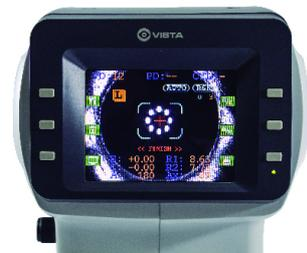
Efetue simultaneamente as medidas de Refração e Ceratometria, ou opte por fazê-las separadamente.
