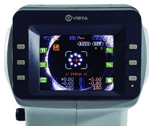
O novo software "Auto Measure" permite ao centralizar a pupila que o aparelho registre automaticamente de 3 até 10 medidas calculando a média dos registros, sem a necessidade de intervenção do operador.
