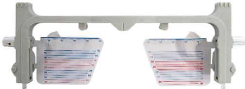
Aparelho manual para medição de altura em armações.
